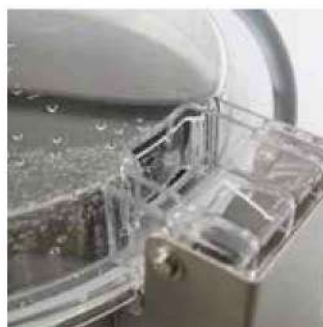
Sistema anti-retorno en la entrada de agua.
