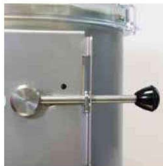
Sistema anti-retorno en la entrada de agua.
